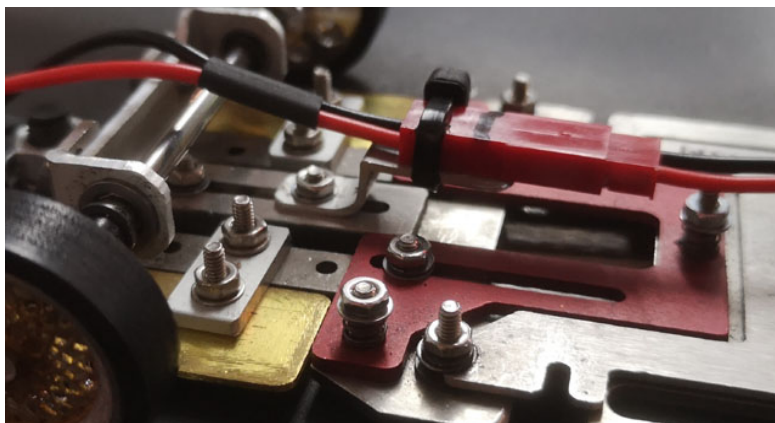
Bild 04: Beispiel für einen Halter aus Aluminium zur Führung des Anschlusskabels zum Leitkiel.
